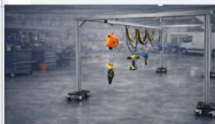
TOOLRAIL minitravers med to akser og tverrkjøring
